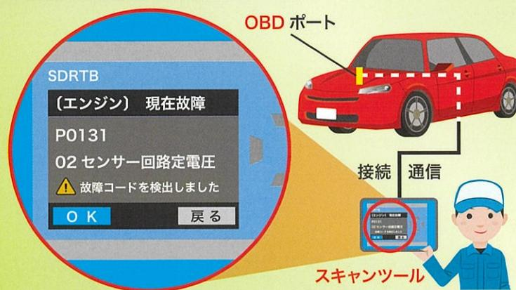
「スキャンツール」をOBDポートに接続し、「OBD」が記録している、各種装置の故障の有無や作動状況（故障コード）を読み出します。これにより、装置が正常に作動しているかを確認することを、「OBD点検」と呼んでいます。
